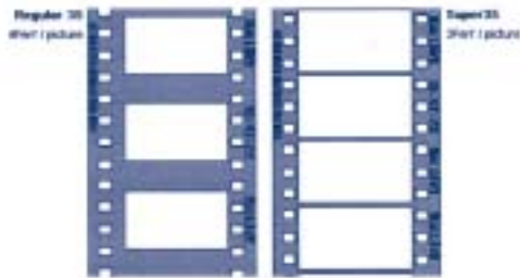
Obsérvese el mayor aprovechamiento de la capa sensible de la película en el sistema de 3P, con respecto al sistema tradicional de 4P.
